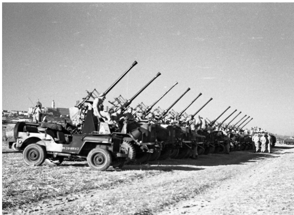
40 mm armaty przeciwlotnicze Bofors na podwoziach samochodów Morris Commercial C9B 2. Pułku Artylerii Przeciwlotniczej 2. Warszawskiej Dywizji Pancernej, Święto Żołnierza, Loreto, 15 sierpnia 1945 r. (IPMS)
