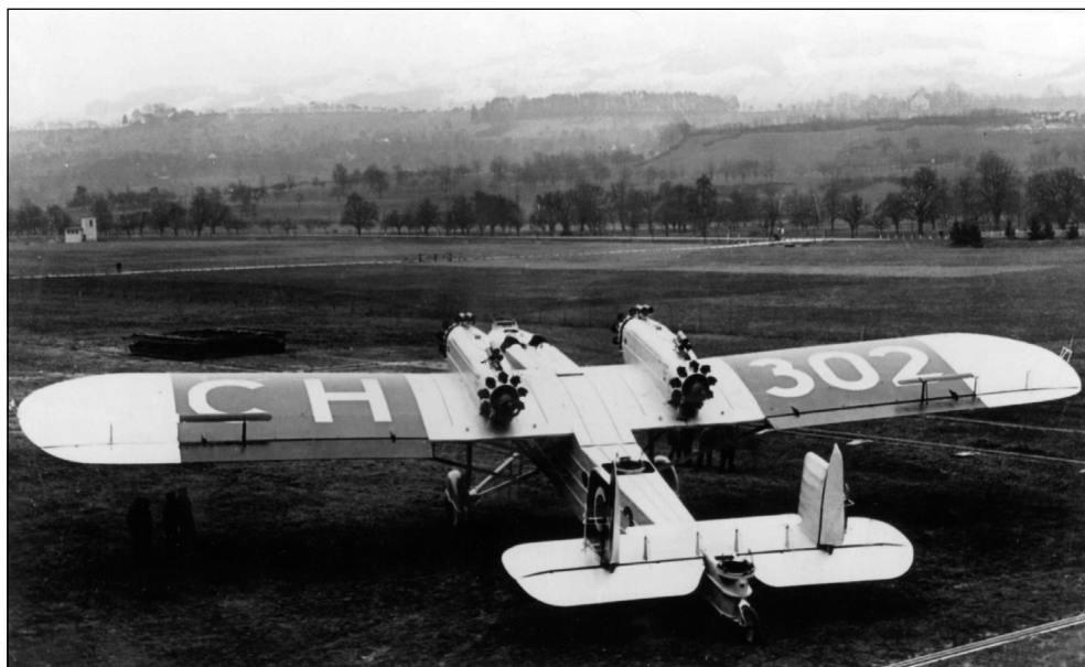
Jedno z wcieleń douhetowskiego bombowca 2000 KM – niemiecki czterosilnikowy Dornier Do P. Dla kamuflażu oficjalnie zaklasyfikowano go jako nocny samolot transportowy. Na zdjęciu w Szwajcarii, gdzie wyposażono go w stanowiska strzeleckie, ok. 1930 r.
