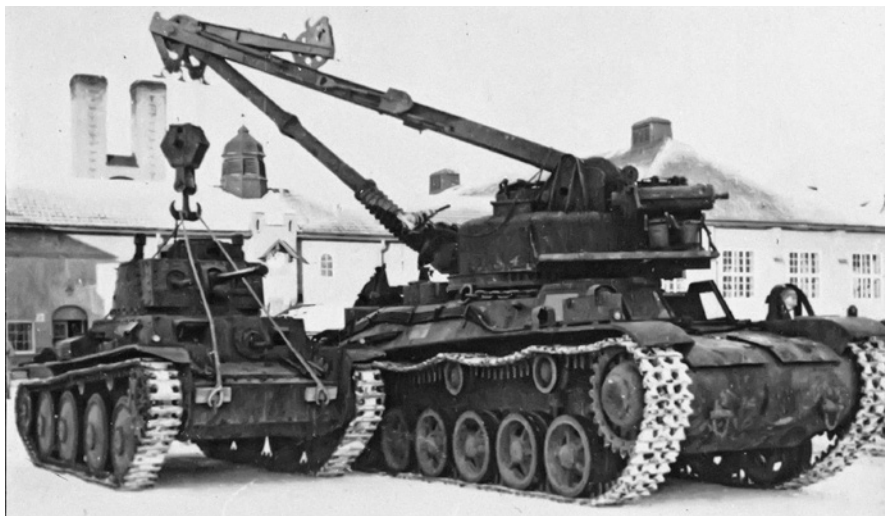
Próby Bärningsbandvagn m/43 w regimencie P3, Strängnäs (AN/Arsenalen)
